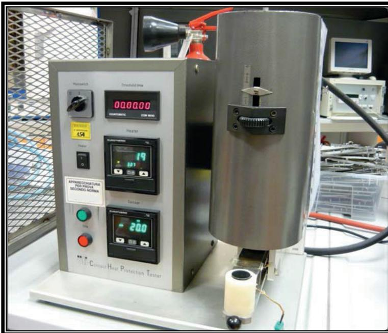
**Figura 6.** Strumentazione utilizzata per la valutazione della trasmissione del calore da contatto.
