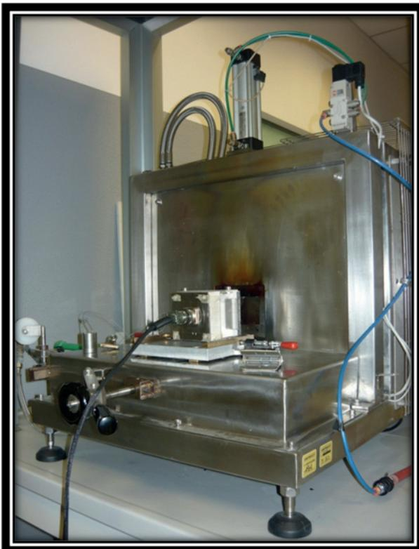
**Figura 5.** Strumentazione utilizzata per la valutazione del comportamento dei materiali quando esposti ad una sorgente di calore radiante.
