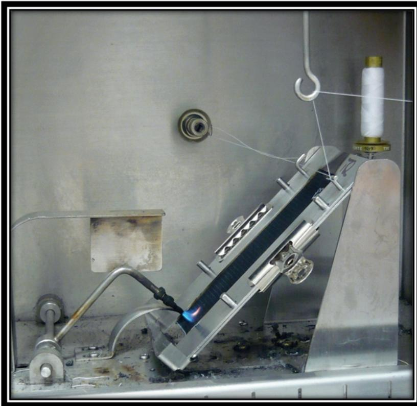
**Figura 2.** Strumentazione utilizzata per la valutazione dell'infiammabilità dei tessuti per abbigliamento (Norma americana).
