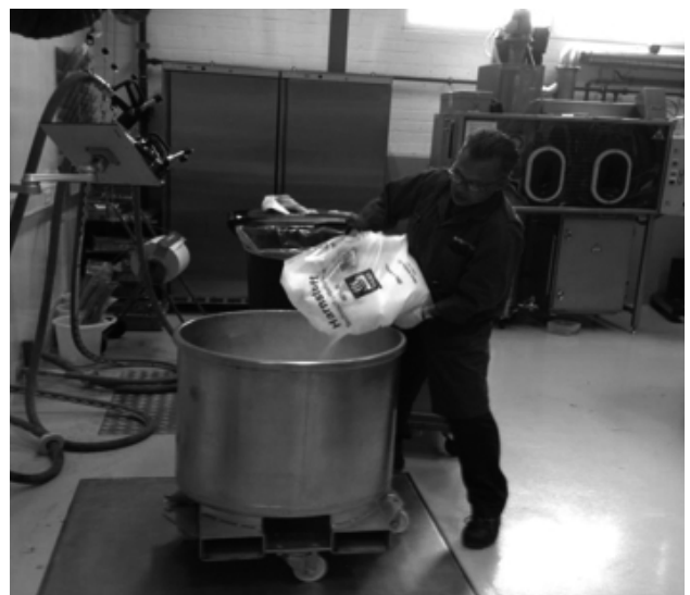
Figura 15 - Miscelatura in serbatoi da 500 kg e pesatura
