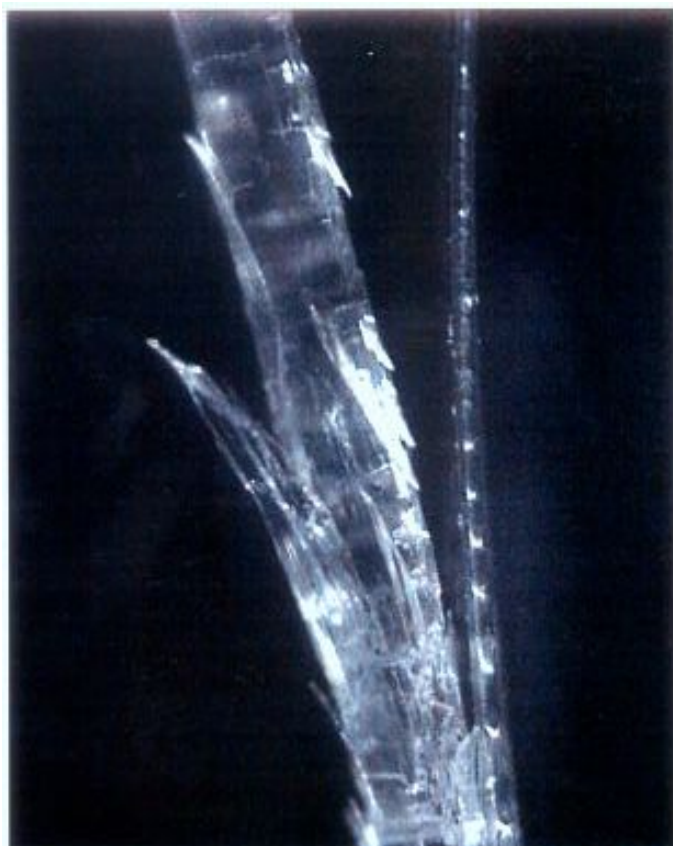
Monofilamento di PA 6 senza S-EED ( d = 0.6 \text{ mm} )
