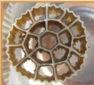
Il film che si produce per attrito dallo spoglio del riempimento deve essere separato a valle del reattore in un sedimentatore
